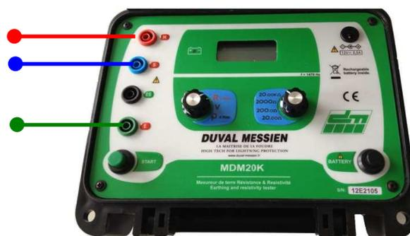
Dans cette méthode un courant ayant une fréquence de 1470 Hz est injecté dans le sol par un générateur intégré dans l'appareil. Par une mesure de tension à un endroit donné, il est alors possible de déterminer la résistance de terre par une simple Loi d'Ohm.
