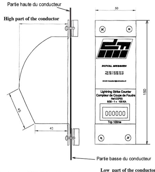
**Fixation :** Le montage se fait en parallèle sur le conducteur de descente à l'aide des 2 brides de serrage et des 4 vis M6x13 (voir schéma à droite).
